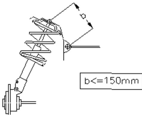
塔顶安装支架可以采用焊接或螺栓连接到车辆壳体上。
