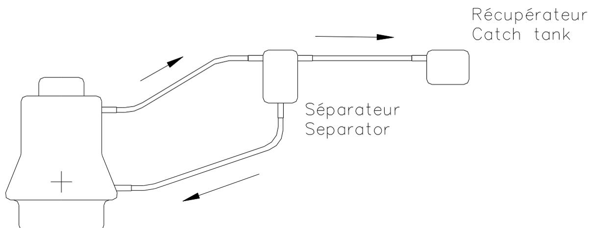
机油必须依靠自身的重力从集油罐 ( oil catch tank ) 流向发动机。
